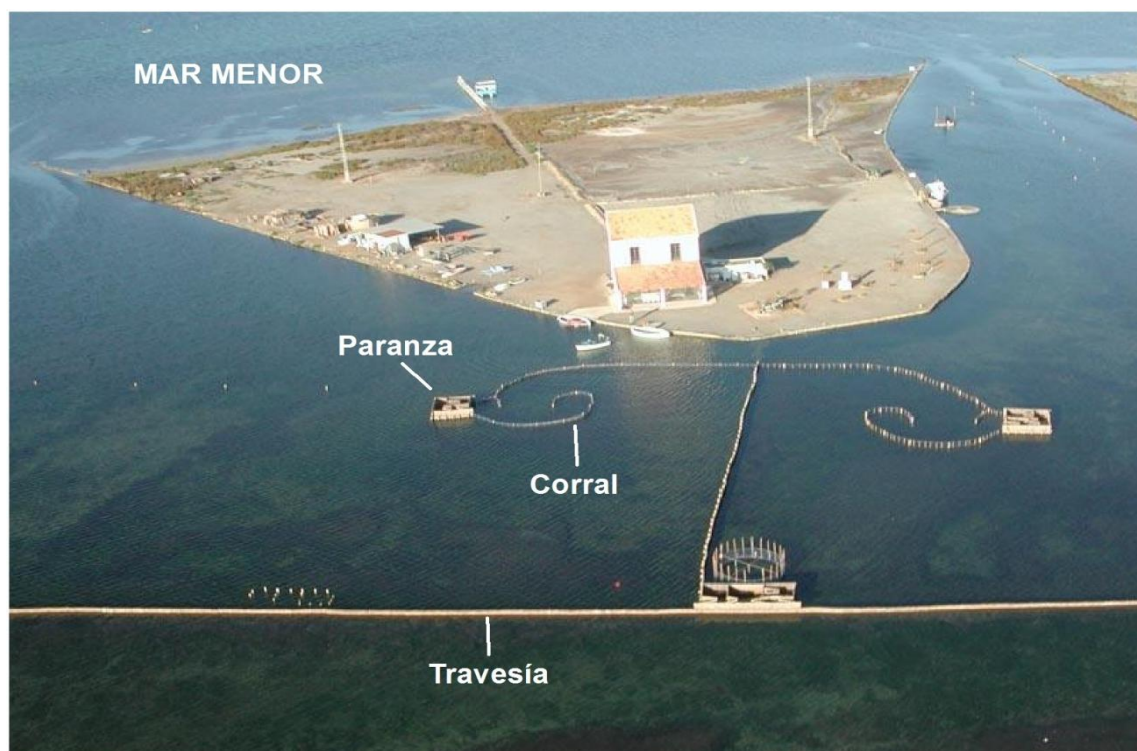
Figura 4. Elementos esenciales del arte de pesca de las Encañizadas.
