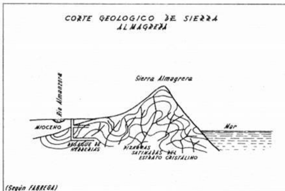
Figura 1. Corte esquemático de las explotaciones de Fábrega (1907), tomada de Sánchez Picón, A. (1986).
